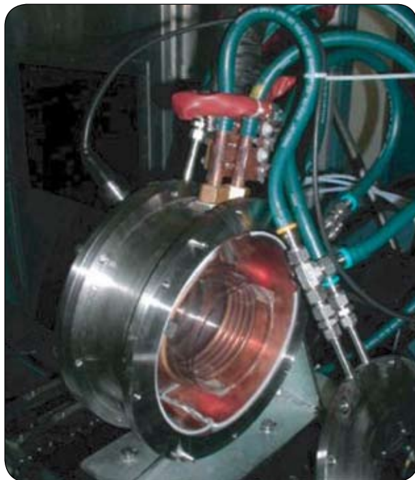
Рис. 8. Электропечь, используемая в методе FCVD
